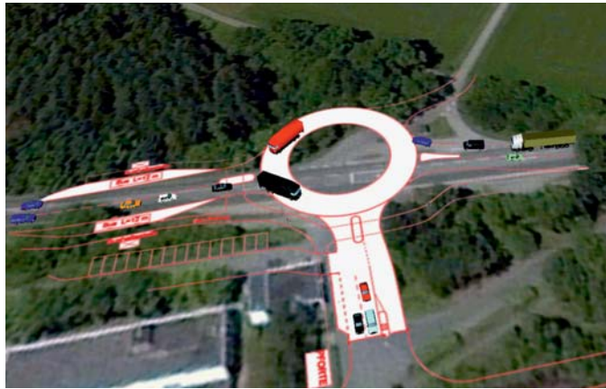
Verkehrsflusssimulation des geplanten Kreisverkehrs für die maßgebliche Spitzenstunde (Video unter: http://www.stadt-land-verkehr.de/Verkehrstechnik_Verkehrssimulation.html )
